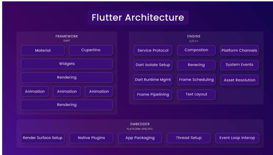
Figure 2.7: Architettura di Flutter [3].
