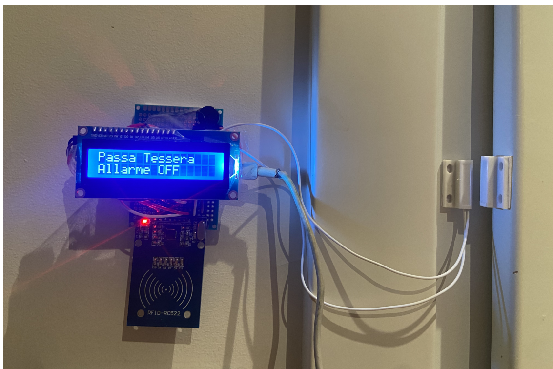
Figura 2.2: Dispositivo ESP32 saldato e applicato
