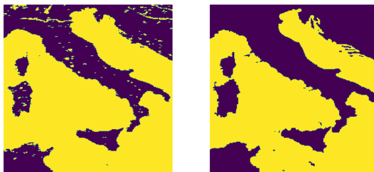
Figura 1.3: A sinistra, la land-sea mask costruita considerando come mare tutti i punti misurati almeno una volta dal satellite Aqua. A destra, la land-sea mask del CMCC, usata nel corso delle sperimentazioni. In percentuale, otteniamo un’area al 59.47% coperta d’acqua.
