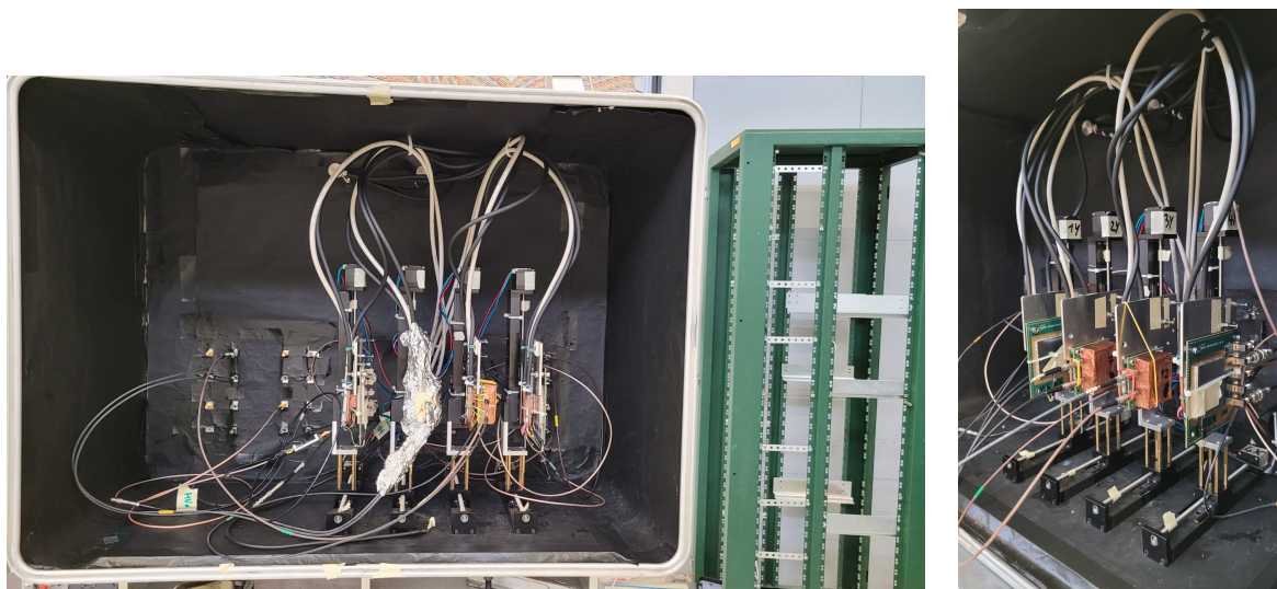
Figura 3.2: I quattro sensori che costituiscono il telescopio: alle estremità i due LGAD, al centro i due SiPM.
