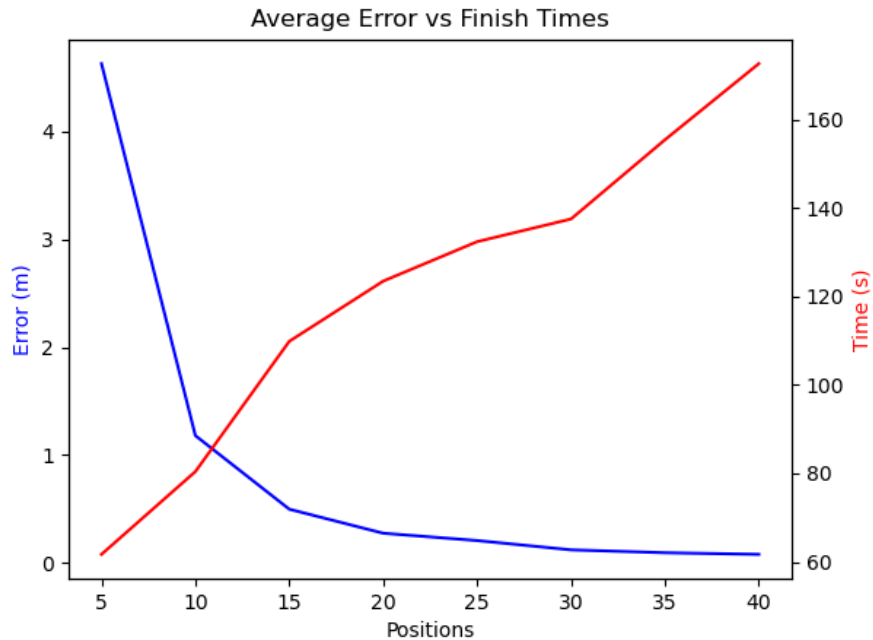
Figura 5.2: Tempo di percorrenza (in rosso) ed errore medio sulla posizione (in blu) di un drone che percorre vari punti di una circonferenza di raggio 50 metri.
