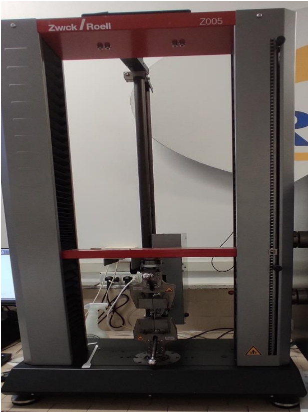
Figura 7.6 Macchina di prova universale per la determinazione delle proprietà meccaniche (Zwick/Roell © Z005).
