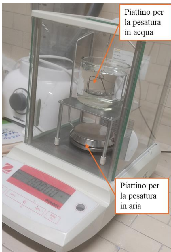
Figura 7.2 Setup per la determinazione della densità del campione.
