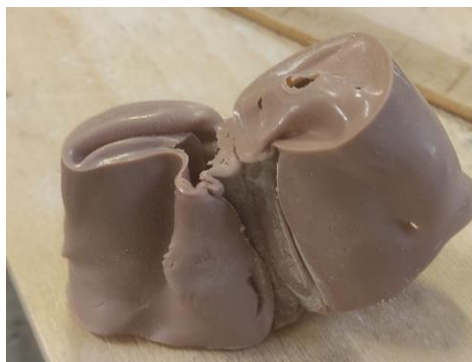
Figura 7.5 Residuo della lavorazione del Brabender (materozza).
