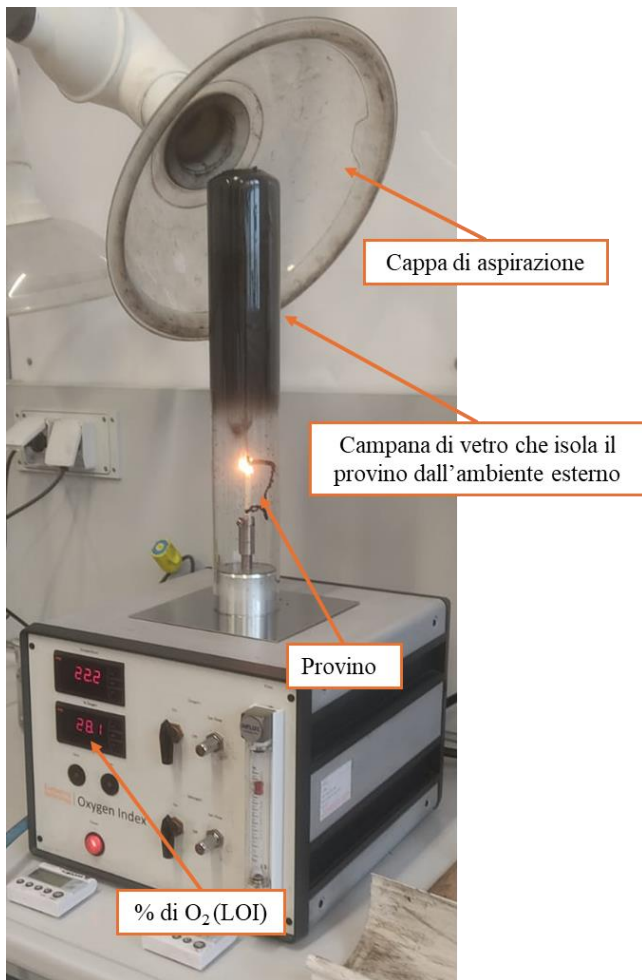
Figura 7.13 Setup per la determinazione del LOI
