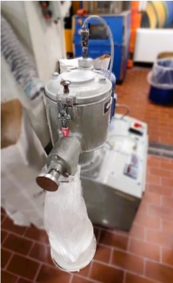
Figura 6.1 Mixer Turbo Henschel (a sinistra) e interno (a destra).
