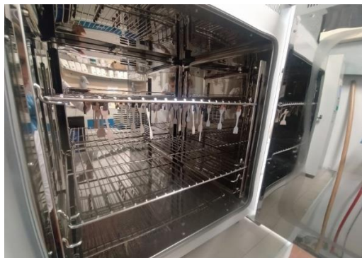
Figura 6.7 Invecchiamento dei provini in stufa.
