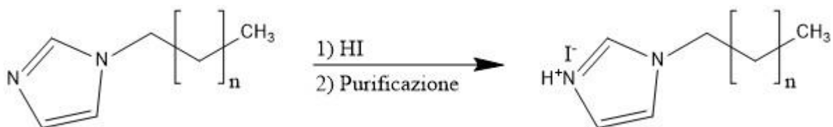
Figura 22: schema di reazione generale del sale ioduro di imidazolio, ( n = 2, 6 o 8 )
