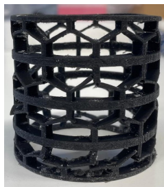
Figura 4.9: Esempio di struttura a doppio strato significativamente danneggiata nello strato più inferiore dopo un test
