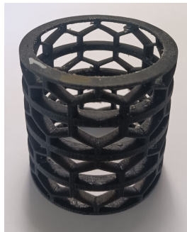
Figura 4.6: Struttura prima di essere testata
