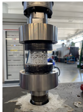
(b). Struttura in fase di compressione
