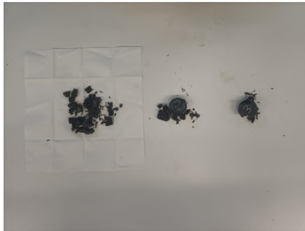
Figura 3.14: Provini in TangoBlack frantumati a seguito dei test
