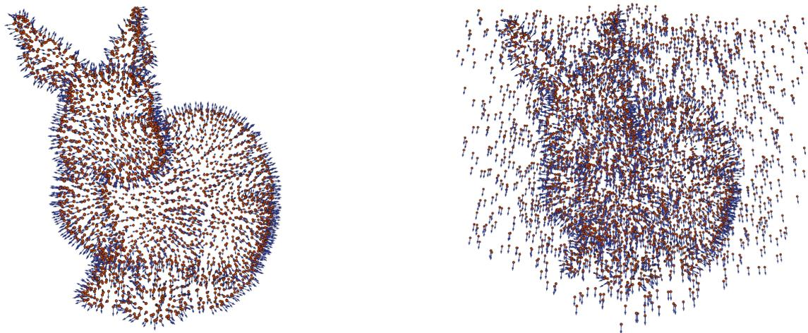
**Figura 3.10:** *Nuvola di punti e normali associate di partenza (sinistra) e con aggiunte (destra).*
