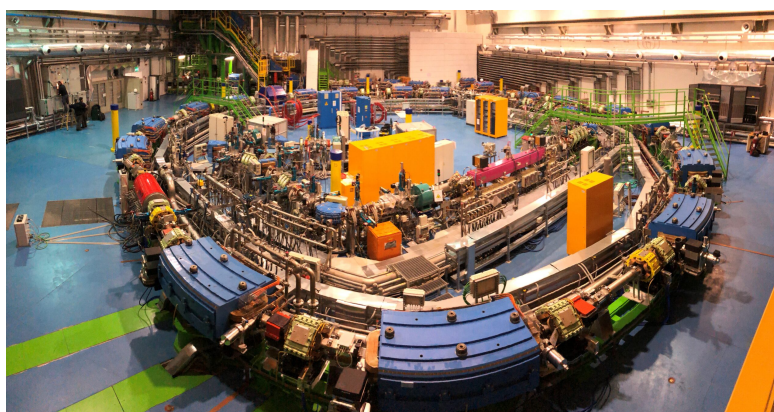
Figura 1.3: Sincrotrone presente al CNAO per il trattamento di pazienti oncologici.
