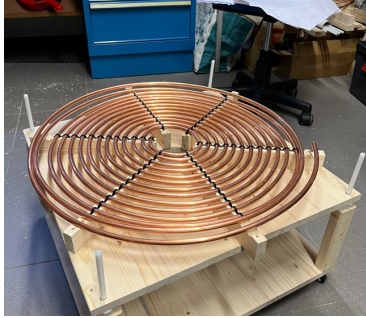
Figura 23: Bobina a pancake di Sparky.
