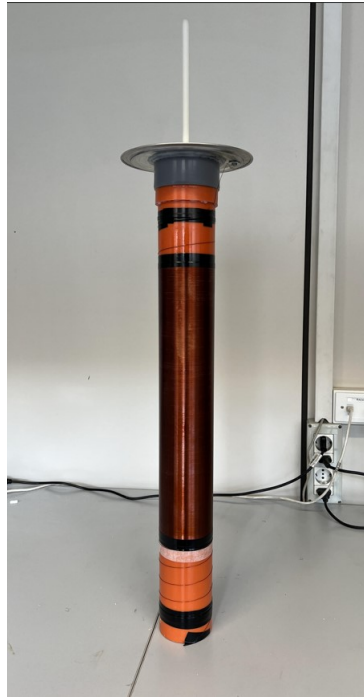
Figura 32: Bobina secondaria di Sparky.
