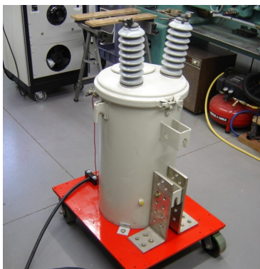
Figura 13: Esempio di trasformatore Pole Pig.
