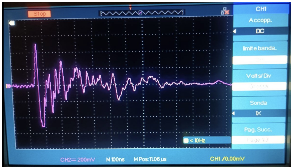
Figura 39: Perturbazione dell'andamento della tensione sul carico superiore prodotta dai fulmini (prima foto).
