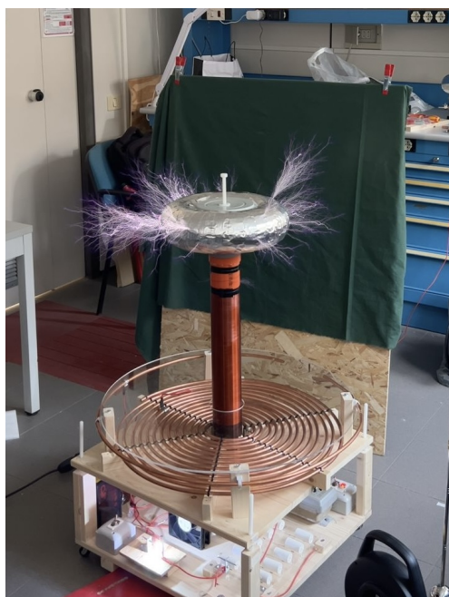
Figura 45: Fulmini prodotti da Sparky con carico superiore toroidale
