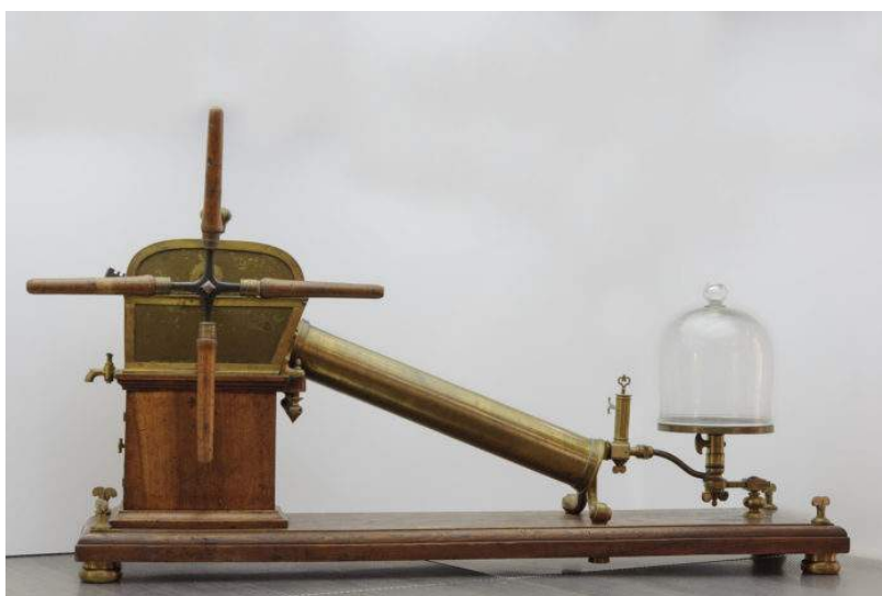
Figura 3: Pompa a vuoto a un solo pistone costruita nel 1697 a Leida da Jan van Musschenbroek e che l'Università di Pisa ebbe in dono da Anna Maria Luisa de' Medici ( Pompa a vuoto n.d.)
