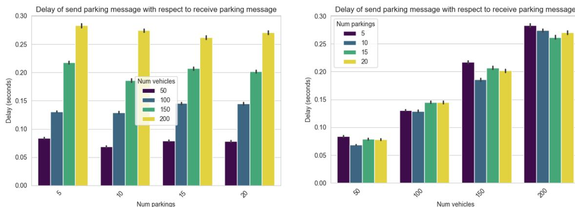
Figura 5.3: Testbed delay senza crittografia per ogni combinazione di parametri
