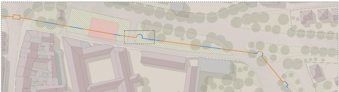
Figura 3.6 Ipotesi di ricucitura delle Mura di San Francesco (in arancione ricucitura raso terra, in blu ricucitura fuori terra)
