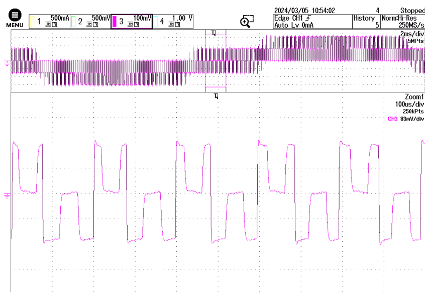
Figura 56: Effetto della modulazione simmetrica
