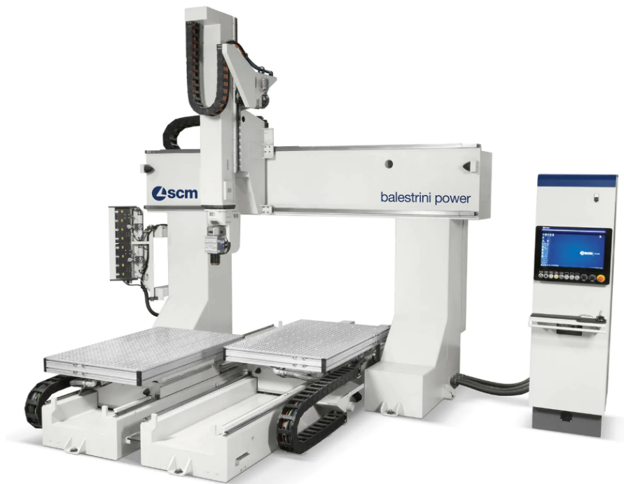
Figura 1.1: Il centro di lavoro Balestrini Power per la produzione di sedie e tavoli.
