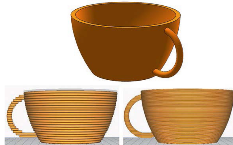
Figura 1.2: immagine CAD di una tazza da tè (sopra). Immagini che mostrano gli effetti della costruzione utilizzando diversi spessori dei layer (in basso). (Gibson et al., 2021)
