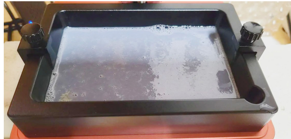
Figura 3.5: dettaglio dello stato turbato della resina dopo il riempimento della vaschetta.
