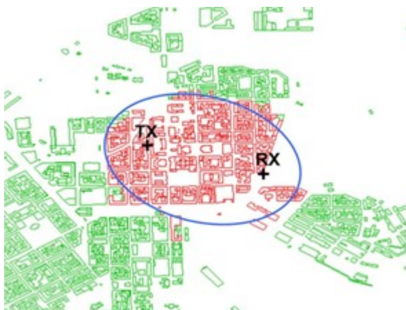
Figura 3.5: Esempio di edifici “attivi” secondo il parametro A dove in verde viene rappresentata la mappa completa e in rosso quella semplificata [3]
