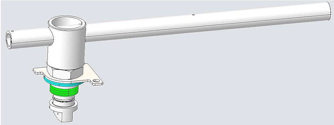
Figura 10.25: Meccanismo di azionamento e spegnimento manuale completo della valvola a sfera flottante
