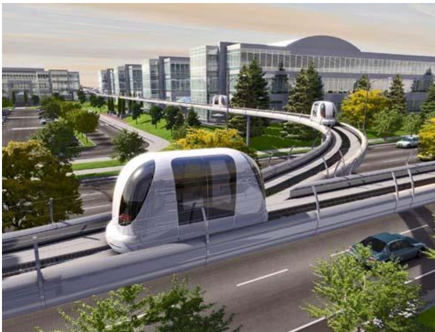
Figura 4.7: Esempio di linea PRT con guida sopraelevata.
