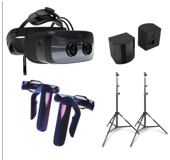
Figura 3.2: Headset con sensori spaziali (SteamVR)
