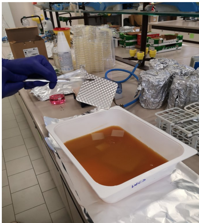
Figura 11: Estrazione del materiale in acciaio trascorsa una settimana in ammollo.
