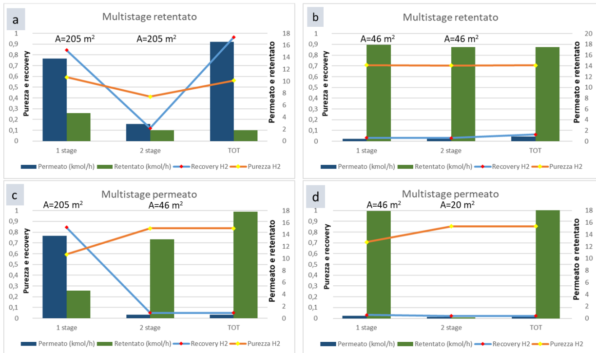
Fig.62: Confronto delle performance di separazione di sistemi a membrana in PEI Ultem®1000B a doppio stadio per il a) b) retentato e per il c) d) permeato, al variare dell'area dei moduli e per una corrente da trattare di 18,34 kmol/h
