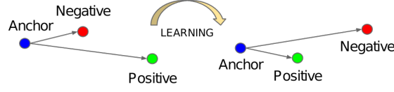
Figure 2.16: Funzionamento della triplet loss.
