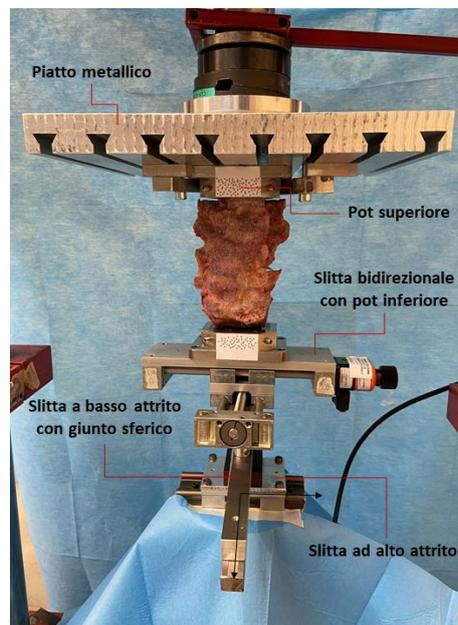
*Figura 2.8. Set up utilizzato durante i test di flessione e estensione.*
