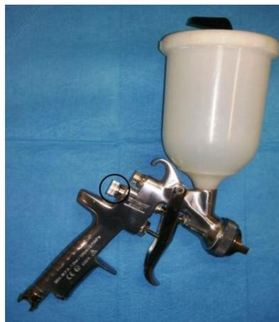
Figura 2.6. Aerografo a pistola con evidenza sulla manopola della regolazione del flusso di vernice.
