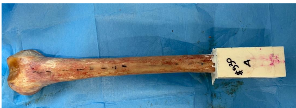
Figura 12: Provino anatomico al termine del processo di ancoraggio
