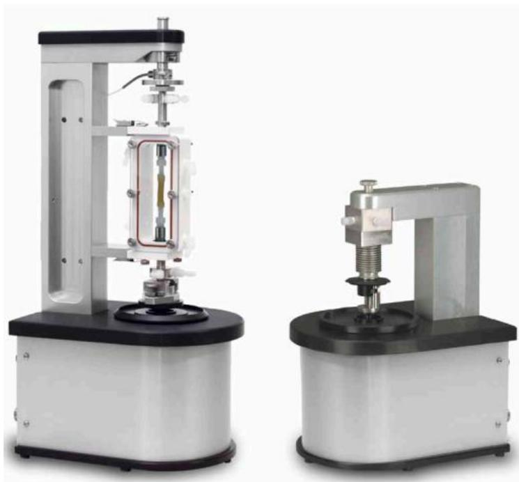
*Fig.45 L'immagine rappresenta il bioreattore a stimolazione meccanica "ElectroForce" utilizzato durante lo studio.*
