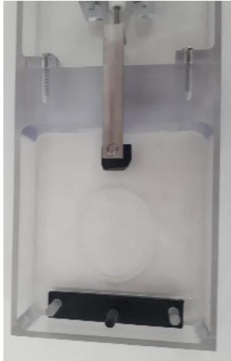
*Fig.35 Le immagini rappresentano il bioreattore a stimolazione meccanica (MCB1, CellScale, Waterloo, Ontario, Canada) utilizzato durante lo studio.*
