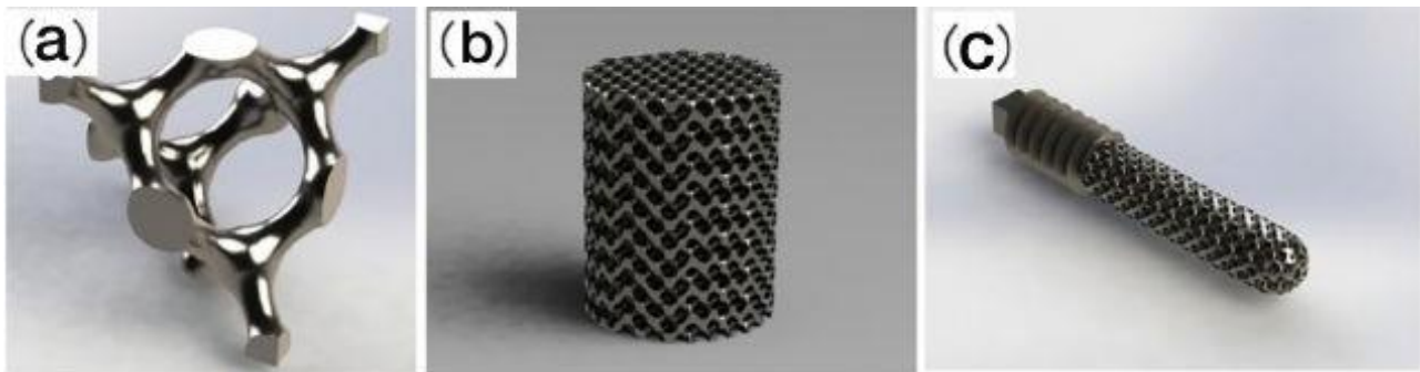
Figura 17: Architetture biomimetiche di scaffold porosi di lega Ti6Al4V. (a) Singola unità simile a un diamante; (b) Campione standard per la prova meccanica; (c) Impianto per esperimento in vivo. Adattato da [64].
