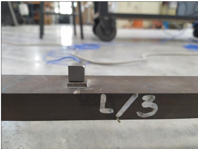
Figura 3.13 Accelerometro posizionato ad L/3 e fissato con perno filettato
