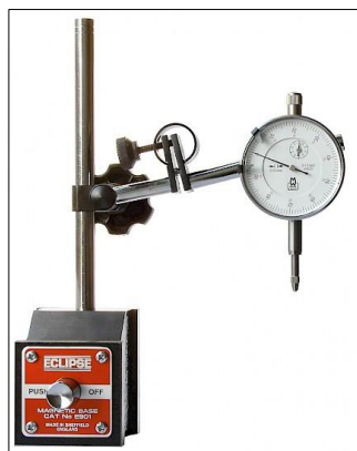
Figura 3. 24 Comune utilizzo della base magnetica – sostegno per un comparatore meccanico
