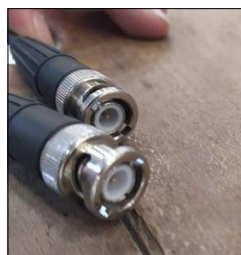
Figura 3.10 Cavi VLC di collegamento per il martello ad impatto
