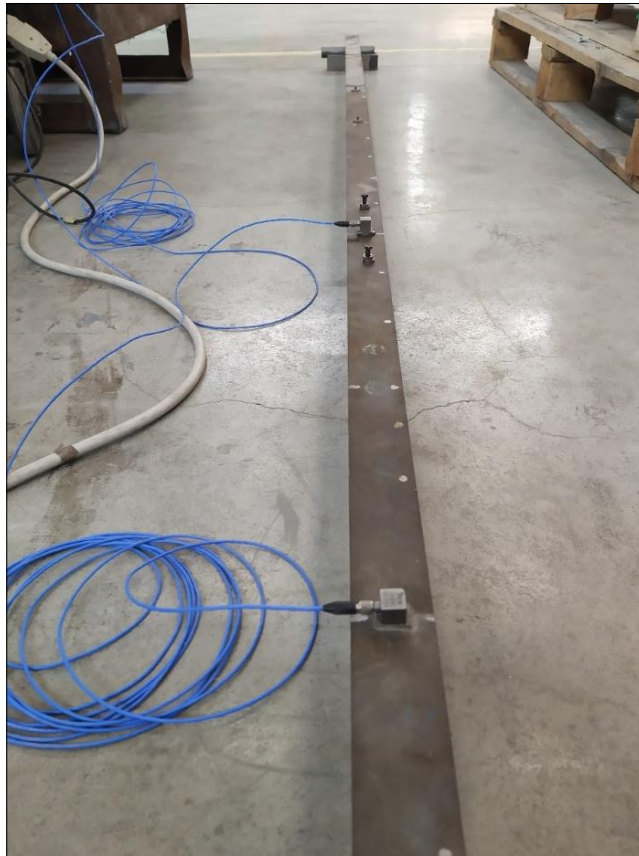
Figura 3.11 Accelerometri montati e collegati alla trave appoggiata
