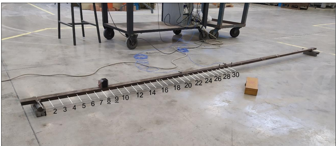
Figura 3. 27 Riferimento fotografico al set-up di prova, Indagini 4 e 5 – configurazione a 30 DOF - irrigidimento inserito tra i nodi a) 16-17; b) 11-12; c) 8-9
