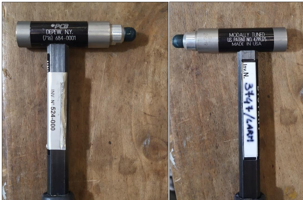
Figura 3.7 Dettaglio del martello ad impulso utilizzato per le prove
