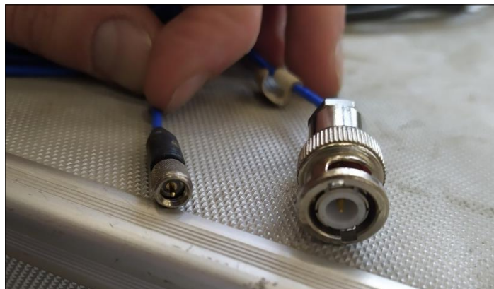
Figura 3. 15 Dettaglio del cavo di collegamento degli accelerometri piezoelettrici
