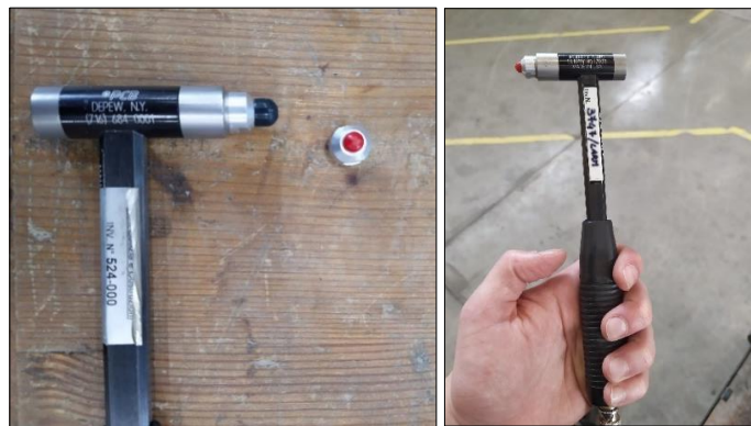
Figura 3.9 Dettaglio delle punte utilizzate per effettuare le prove
