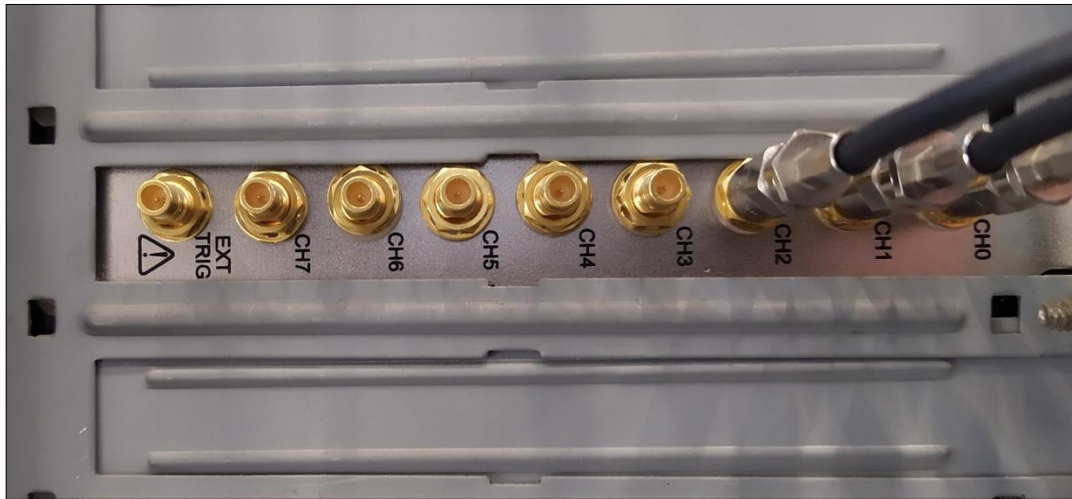
Figura 3.4 Pannello di collegamento della scheda di acquisizione
