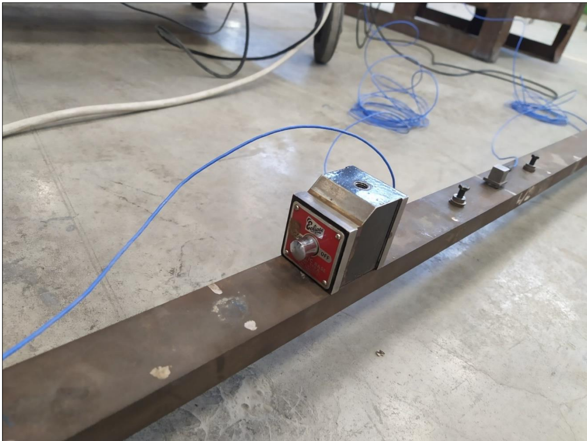
Figura 3.22 Applicazione della base magnetica alla trave metallica
