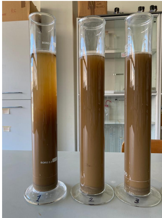
Figura 25. Cilindri sedimentatori con i campioni di suolo pronti per le letture con densimetro
