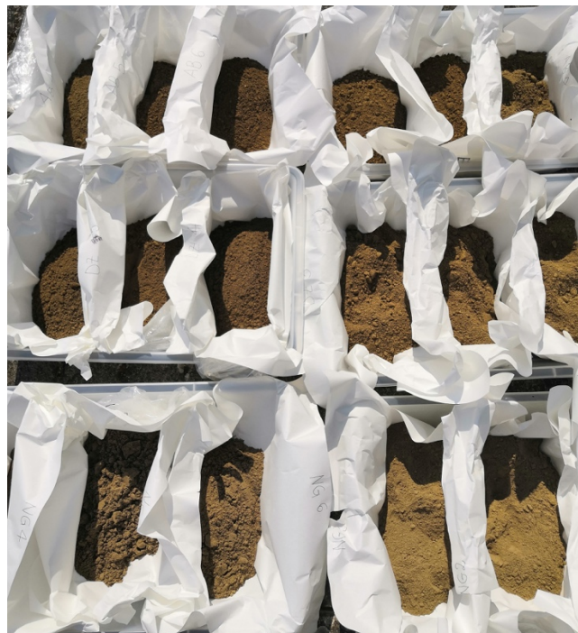
Figura 21. Asciugatura all'aria dei campioni di suolo separati da carta filtro nelle bacinelle
