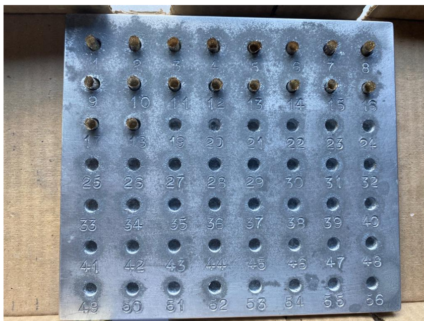
Figura 28. Piastra in alluminio con alloggiamenti e capsule d'argento
