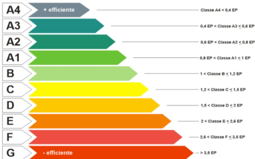
**Figura 7.** Classi energetiche di riferimento determinate in funzione dell'indice di prestazione energetica globale non rinnovabile dell'edificio di riferimento, indicato in figura con EP.
