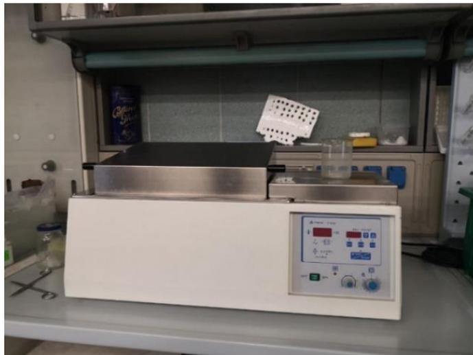
Figura 3.8: Bagno termostato ad agitazione regolabile.
