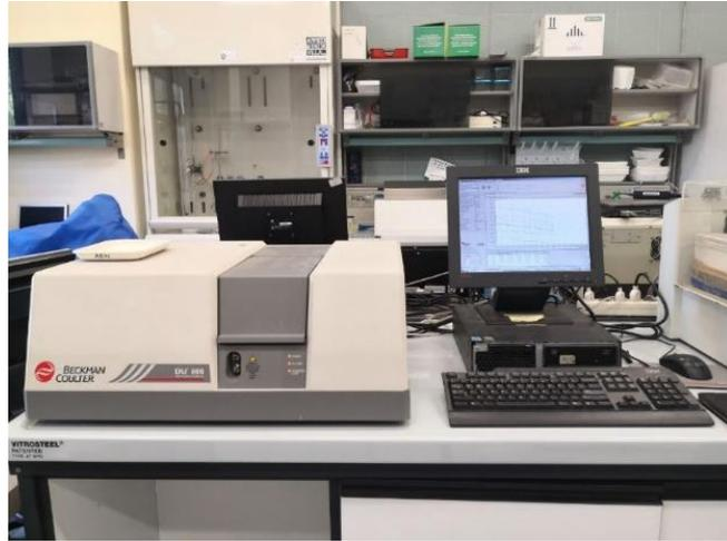
**Figura 3.6: Spettrofotometro Beckman Coulter, DU 800 Spectrophotometer.**
