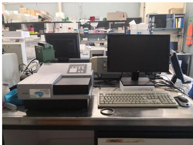
**Figura 3.7: Lettore spettrofotometrico per micropiastre Biotek EL 808.**
