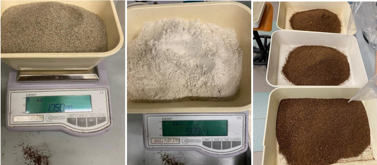
Fig 3.8. Sequenza di immagini che raffigurano il momento della pesatura di ogni componente del suolo artificiale e il miscelamento delle varie componenti.
