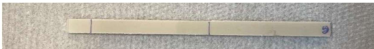
*NOTE: le dimensioni del provino sono definite nella norma tecnica ASTM D2863; nel caso in esame le dimensioni sono: lunghezza = 10.5 cm; larghezza = 6.2 cm; spessore 3 mm)*
