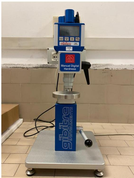
Figura 20: strumento utilizzato per le prove di durezza
