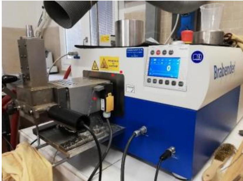
*Figura 26: il plasticorder utilizzato (Brabender Plastograph EC + Mixer W50)*
