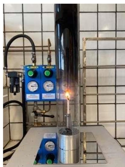
*Figura 30: a sinistra: strumento utilizzato per la misurazione del LOI; a destra; provino durante la prova*
