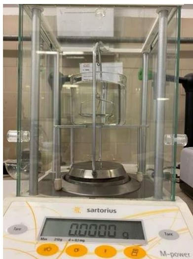
Figura 25: bilancia per calcolo densità relativa
