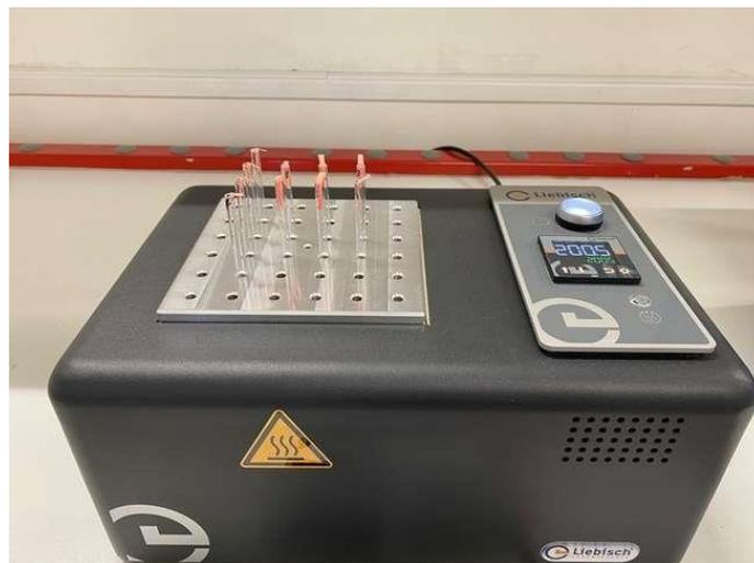
*Figura 31: strumento utilizzato per la misurazione del valore di congo rosso*
