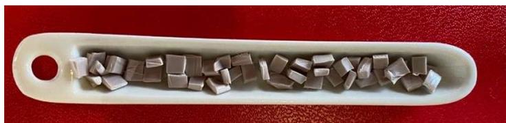
*Figura 34: navicella di ceramica per forno tubolare*
