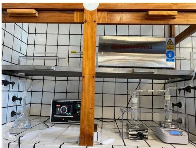
*Figura 33: forno tubolare*
