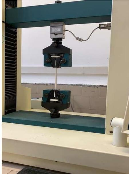
*Figura 21: strumento per prove di trazione*
