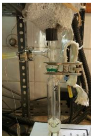
Figura 13. Gorgogliatore in vetro e sistema laterale di uscita al vent.
