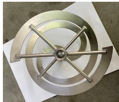
Figura 2.6: Girante Helical Ribbon vista dall'alto.
