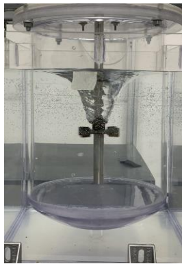
Figura 1.2: Sistema in condizioni subcritiche.
