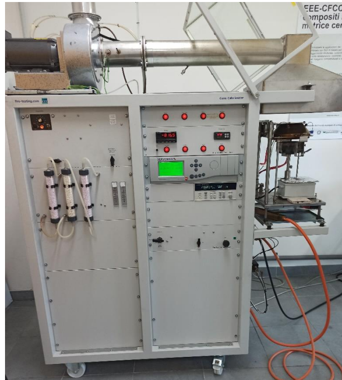
Figura 26- Cono calorimetro di Faenza, prodotto dalla Fire Technology Ltd.
