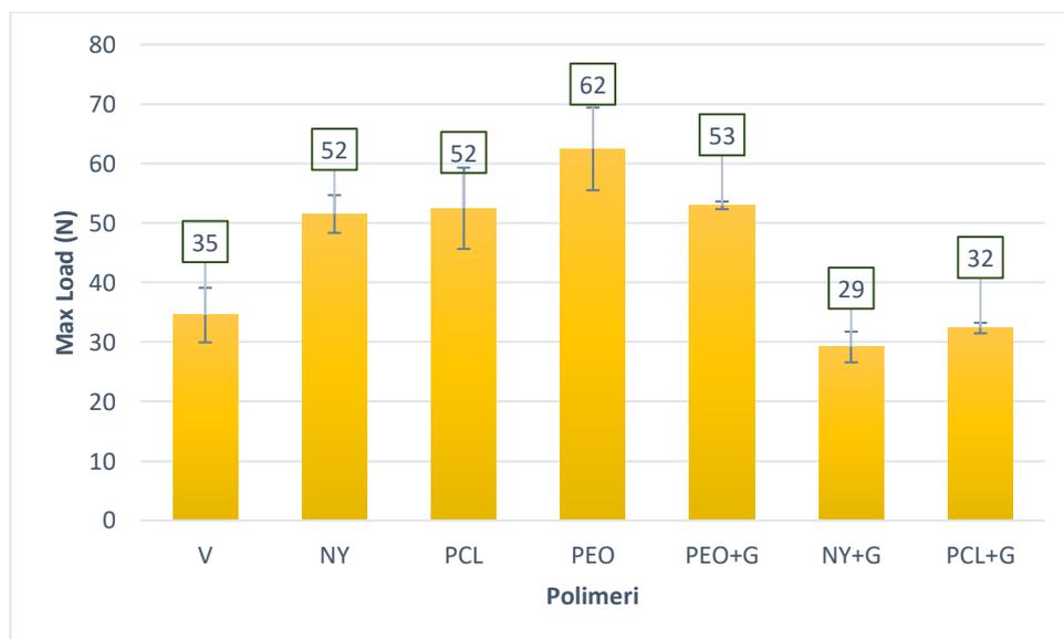
Figura 3.19- Valori di forza massima registrata per provini testati in Modo I
