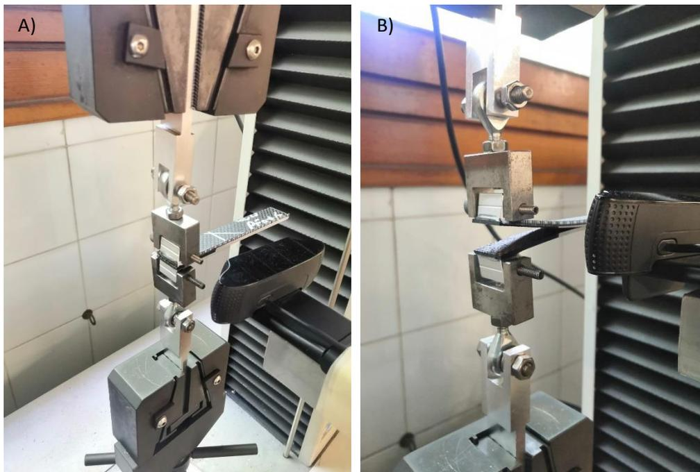
Figura 3.15- A) Set-up iniziale della prova; B) Provino in corso di delaminazione
