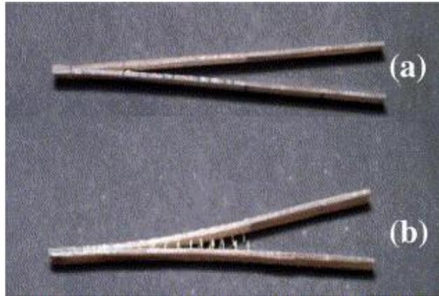
Figura 1.13- Provino per test DCB: a) non cucito b) cucito [13]
