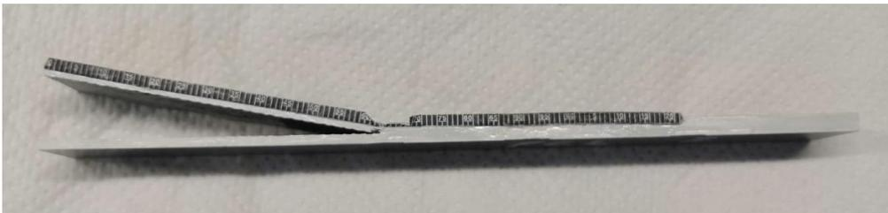
Figura 3.23- Provino delaminato a seguito della prova
