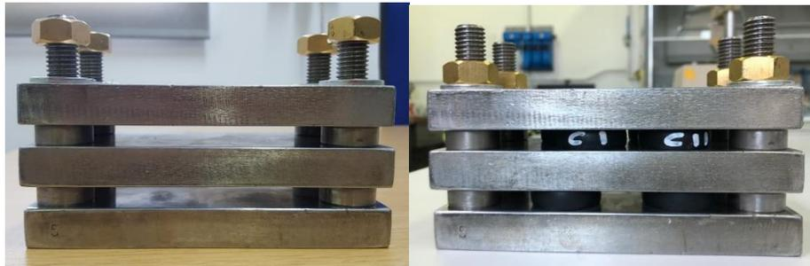
Figura 56. Distanziatore metallico vuoto (sx) e contenente i provini per compression set (dx).
