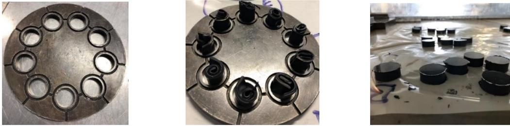
Figura 41. Sopra: preparazione provini per prove tensili e lacerazione. Sotto: preparazione provini per compression set.
