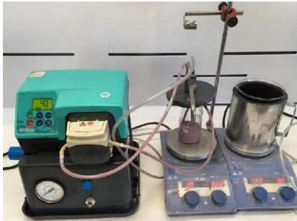
Figura 2.1: sistema Spray-Freeze-Drying LAB-SCALE granulator LS-2 utilizzato.
