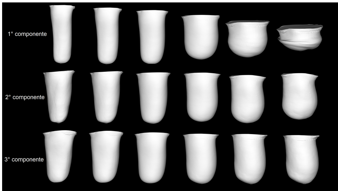
Figura 4.21: Forme generate dalla PCA a partire dal dataset di test al variare dei pesi associati alle componenti.
