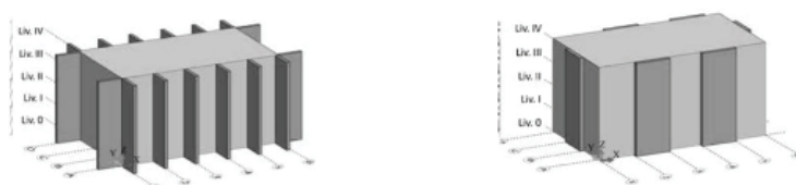
Figura n.30: Pareti di taglio perpendicolari e pareti di taglio parallele al piano di facciata. [Fonte 44 ]
