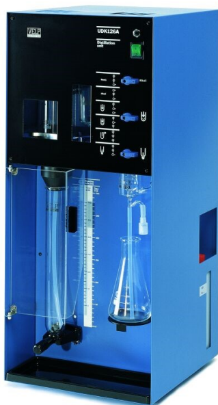
Fig. 19 Kjeldahl distillation unit (UDK) 126A used for Kjeldahl nitrogen determination
