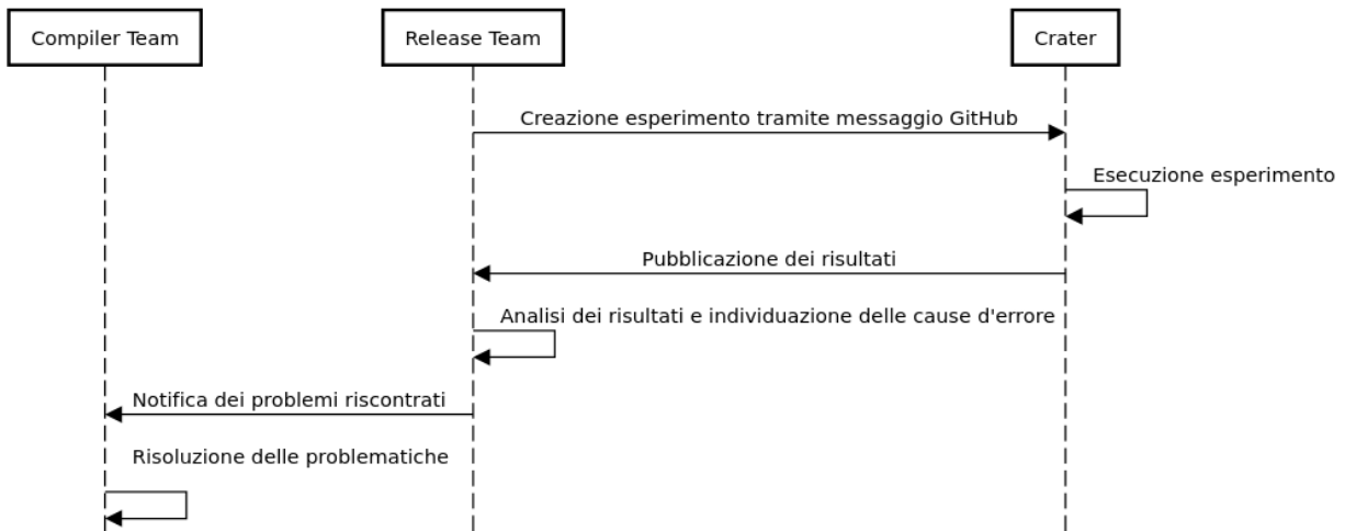
Figura 1.2: Processo di analisi di modifiche al compilatore tramite Crater
