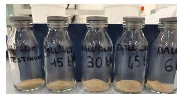
Figura 8 Omogeneizzazione con mortaio e preparazione dei campioni in vial da 40 mL
