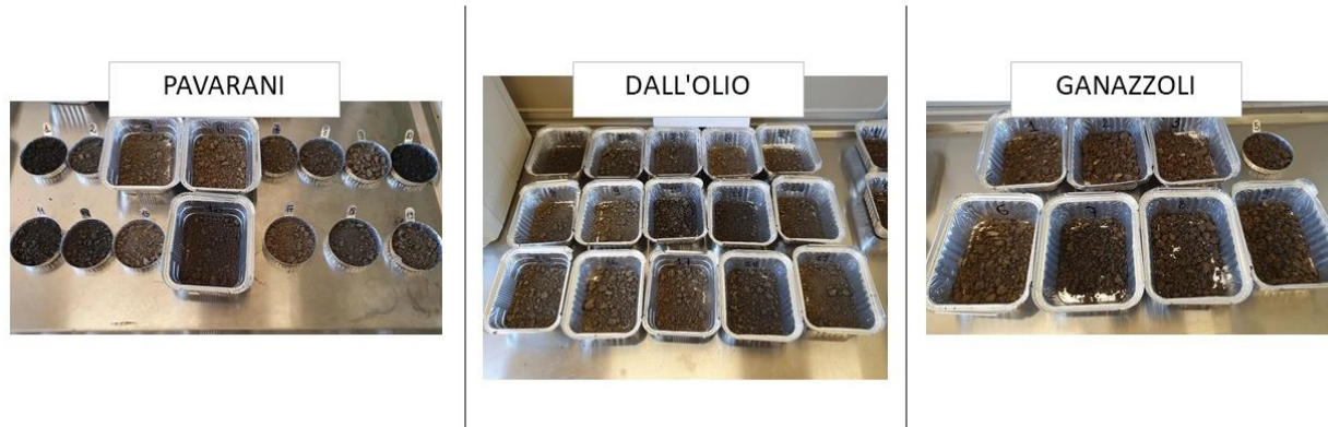
Figura 7 Suoli analizzati, suddivisi in vaschette di alluminio per l'essiccazione, la setacciatura a 2 mm e la successiva omogeneizzazione con pestello e mortaio
