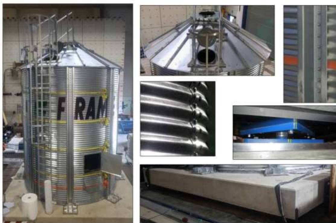
Figure 3.1 struttura testata e relativi particolari strutturali: silo (sinistra), tetto (in alto al centro), montante (in alto a destra), virola corrugata (al centro), isolatore (a destra al centro), platea di fondazione (in basso a destra).
