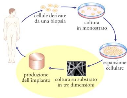
Figura 1.4. Procedura di realizzazione dello scaffold .
