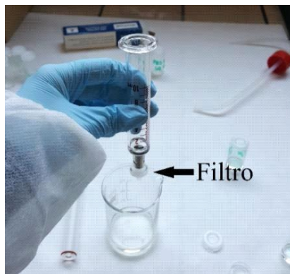
Figura 3.11 Filtrazione dei campioni disciolti nel solvente
