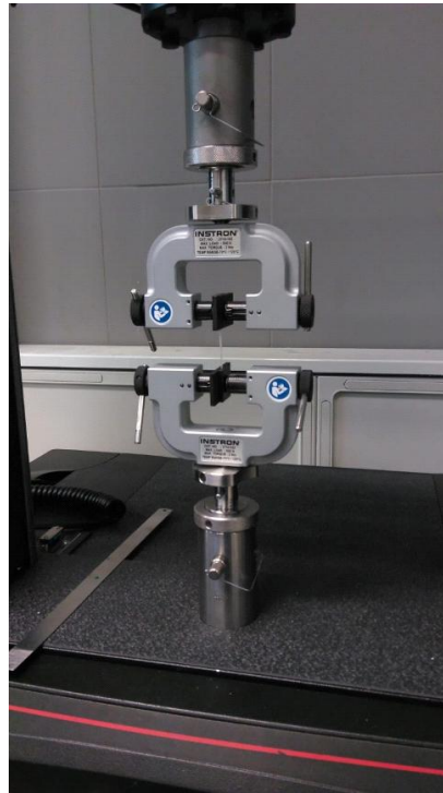
Figura 3.19 Scaffold sottoposto a trazione
