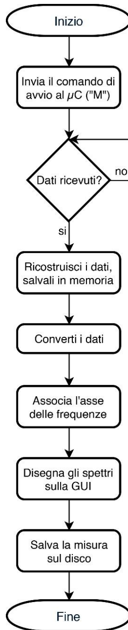
Figura 48 - Diagramma di flusso delle operazioni svolte dal software per svolgere la misura.
