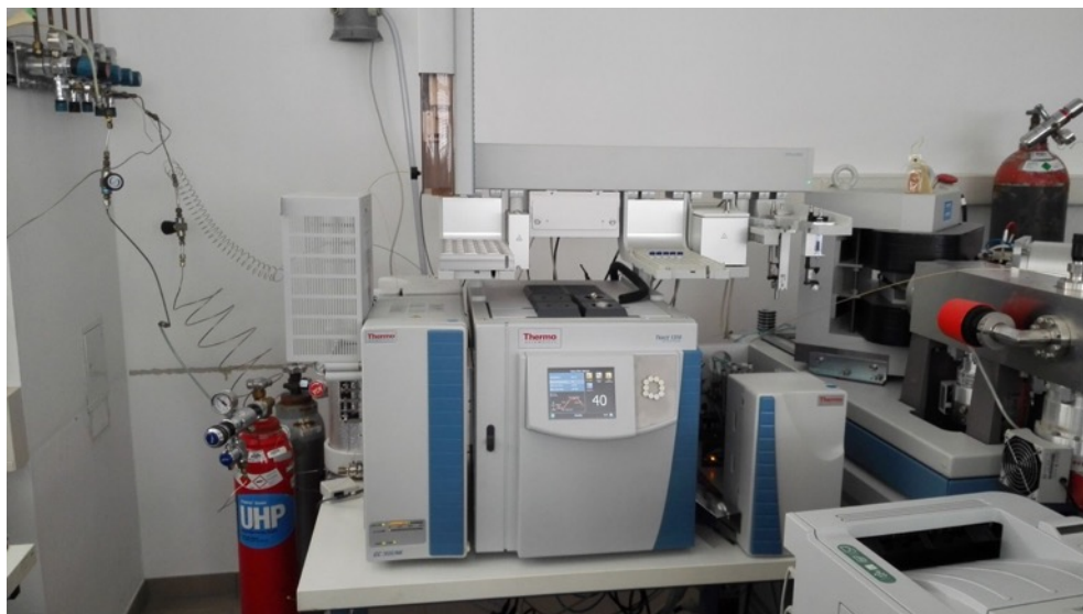
Figura 44: "GC/C-IRMS" utilizzato per le analisi isotopiche.
