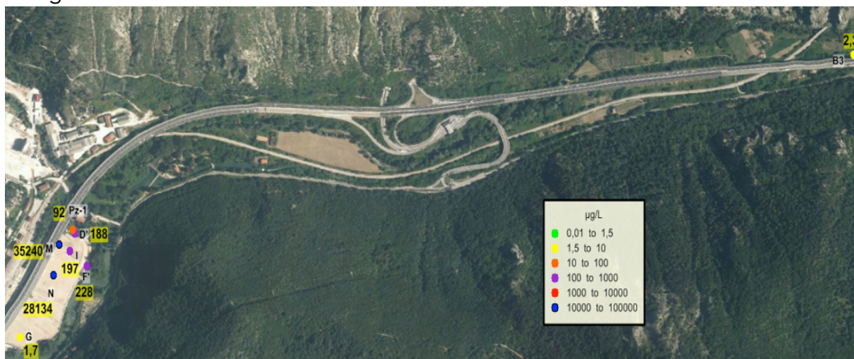
Figura 58: Postmap delle concentrazioni di TCE rilevato nei punti di monitoraggio durante la campagna di campionamento del 2017. La scala dei colori fa riferimento alle concentrazioni suddivise per ordine di grandezza; 0,01 µg/L è il valore di rilevabilità mentre 1,5 è la CSC del TCE. Con le etichette arancioni vengono riportati i valori di concentrazione.
