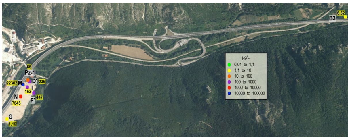
Figura 57: Postmap delle concentrazioni di PCE rilevato nei punti di monitoraggio durante la campagna di campionamento del 2017. La scala dei colori fa riferimento alle concentrazioni suddivise per ordine di grandezza; 0,01 µg/L è il valore di rilevabilità mentre 1,1 ppb è la CSC del PCE. I valori di concentrazione sono evidenziati con l'etichetta gialla, mentre in arancione sono riportati gli identificativi dei piezometri.
